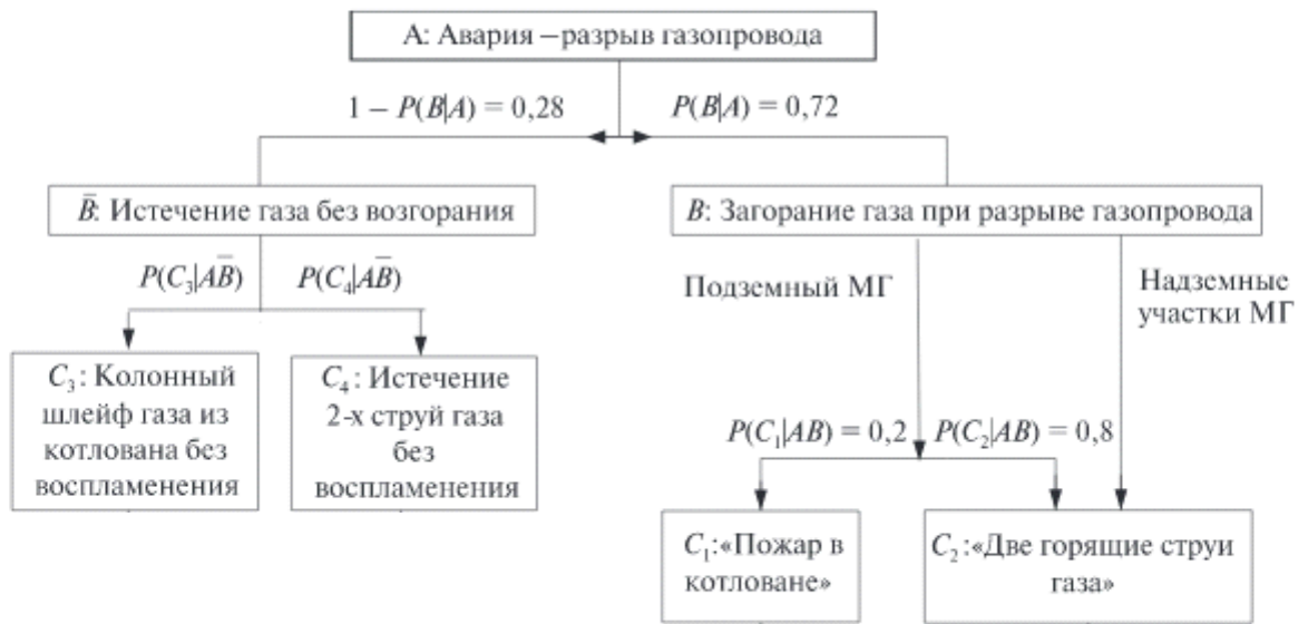
Рисунок 5 – Типовое дерево событий при разрыве газопровода
